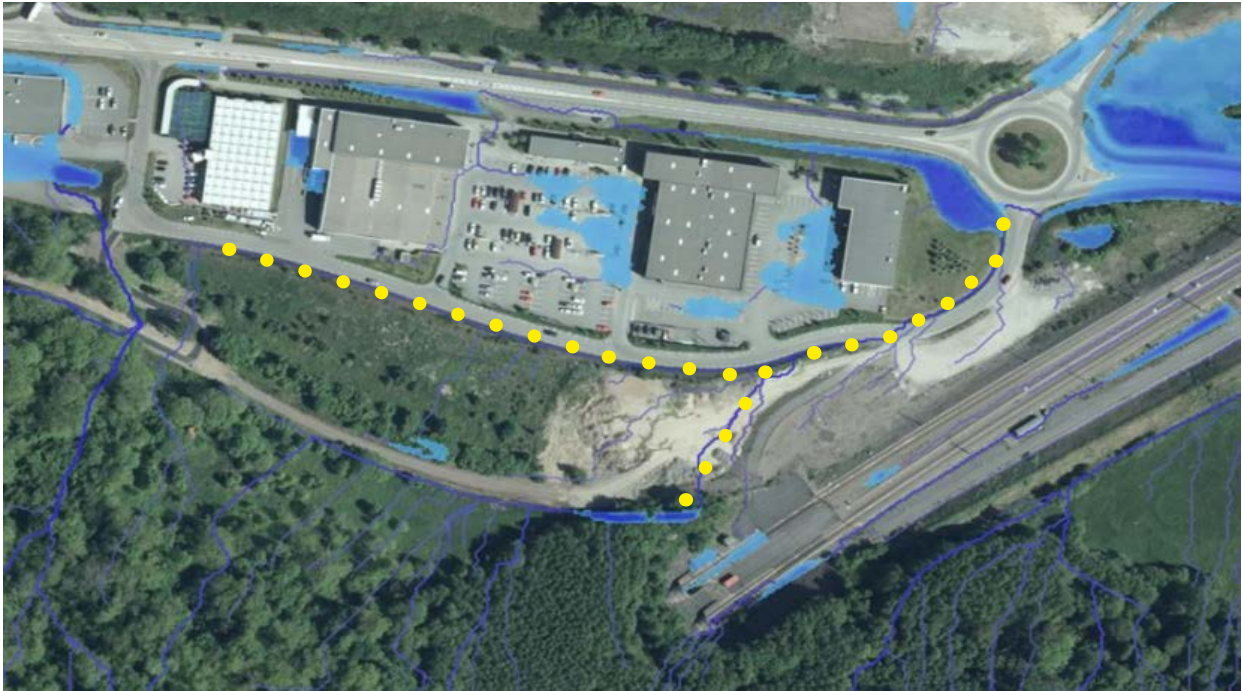
Bildtext: Ytliga rinnvägar och lågpunkter med vattensamlingar djupare än 30 cm i samband med skyfall (bild: Scalgo Live). Färgsättningen på djupet är gjort med en gradient, exakt djup går inte att utläsa från bild. Mindre vattendjup än 30 cm visas med en svagare blå färg.
