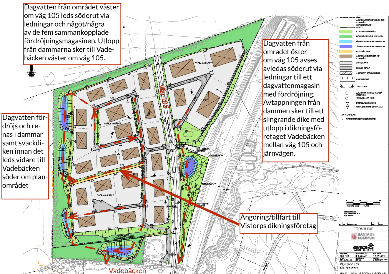
Höjd- och utformningsplan (inkl schematisk skiss över dagvattenhantering) tillhörande Utredning samt förprojektering av dagvattenhantering, VA och vägar för Vistorp 7:19, Sweco 2020-06-01.
